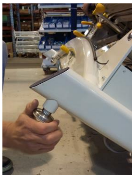
Bild 5: Skruva fast justeringsfötterna
