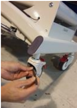
Bild 4: Avmontering hjulen med hjälp av sexkantnyckel
