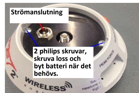
Bild 9. Laddning och byte av batteri
