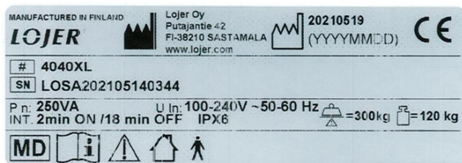
Bild 34: Typskylt (bilden är ett exempel) och dess placering
