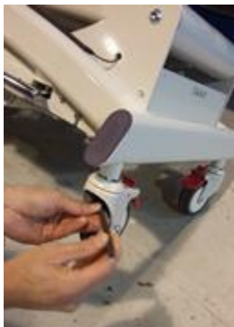
Bild 4: Avmontering hjulen med hjälp av sexkantnyckel
